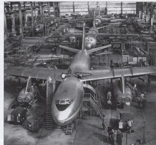
Das erste zivile Strahlverkehrsflugzeug Deutschlands entstand in der Halle 222; im Bild die Montage der Maschinen vom Typ 152/II, vorn die 152 V-4
